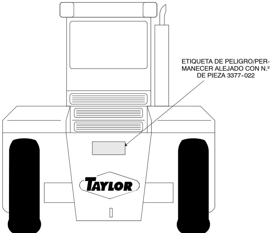
La colocación de la etiqueta n.º 3377-022 tiene que estar centrada horizontalmente entre el logotipo de Taylor y la placa de contrapeso (como se muestra) en la parte posterior de la máquina.
