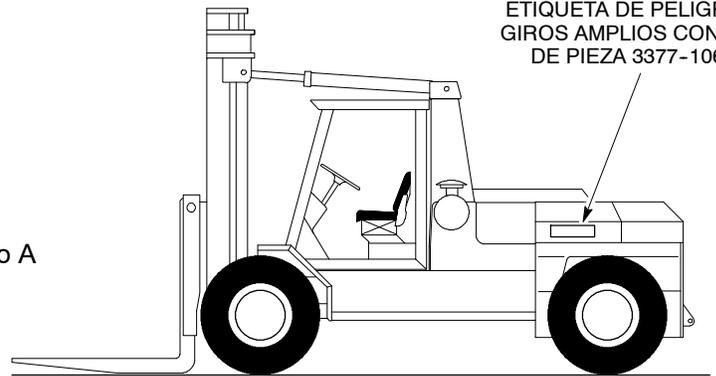
Cómo colocar las etiquetas 3377-106 en el exterior de la máquina... Ejemplo B
