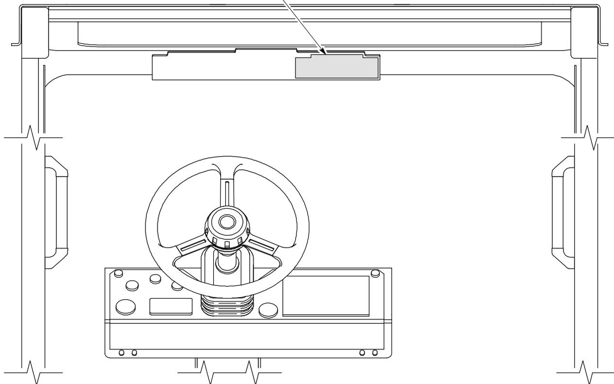
Cómo colocar la etiqueta N.º 3377-170. En la parte derecha de la placa de colocación para la etiqueta adhesiva ubicada delante de la cabina en el travesaño superior.
