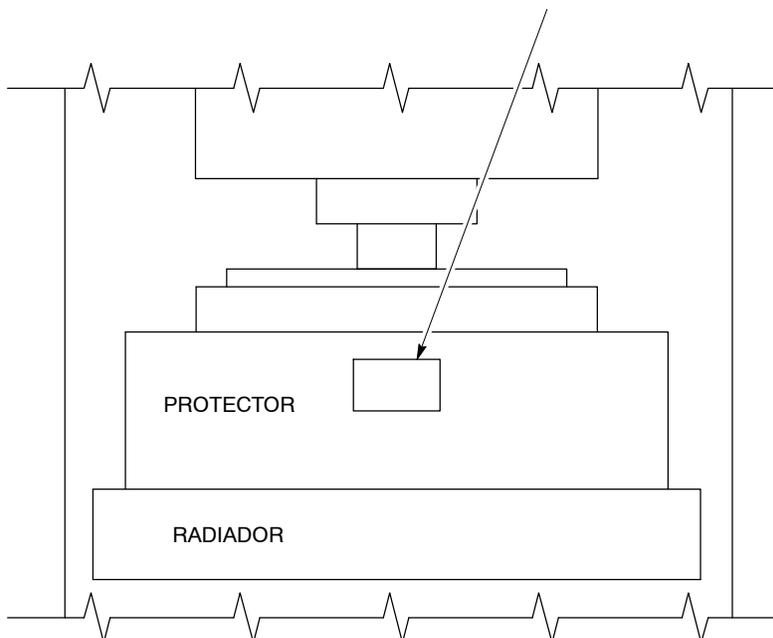
Esta etiqueta advierte al personal para que se mantenga alejado del ventilador si están revisando la máquina con el motor en funcionamiento.
